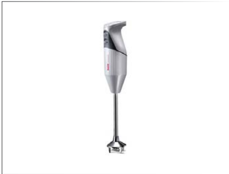
Stabmixer 200 GASTRO Kunststoff/Edelstahl rostfrei 18/10, hellgrau 200 W 2 Geschwindigkeitsstufen Softgrip-Schalter Spiralkabel hellgrau 3 Aufsteckteile (Multimesser, Schlagscheibe, Quirl) verarbeitete Menge: bis 20 l Gesamtlänge 39.5 cm Eintauchtiefe: 29 cm Art. 105439
