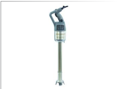
Stabmixer MP450ULTRA Messer, Mischkopf und Stab, Länge 450 mm - Ganz aus Edelstahl Abnehmbarer Mischkopf 100 Liter/h Produktion 290 W, einphasig 230 V 500 W, einphasig 230 V 9500 U.p.M. Abmessungen : Länge 840 mm, ø 125 mm Gewicht: 6,3 kg Art. 126533
