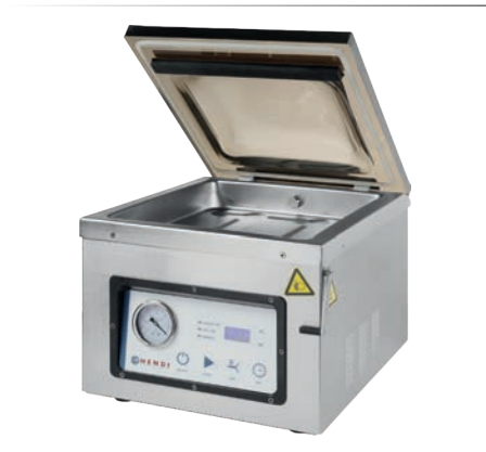
Vakuum Kammermaschine PROFI LINE 300 Dichtungsleiste 300 mm, 5 mm breit. Einstellbare Vakuumier- und Siegelzeit. Wahlweise automatische oder manuelle Bedienung. – Auch geeignet zum Vakuumieren von Flüssigkeiten und feuchten Lebensmitteln. Mit Marinierfunktion. Ausgestattet mit einer Digitalanzeige und einem manuellen Manometer. Die hochwertige Ölpumpe bietet einen hohen Druck (1009 mBar) und kurze Vakuumierzeiten. Gehäuse und Vakuumkammer aus hochwertigem Edelstahl. Die große Aussparung im Boden und der gewölbte Deckel ermöglichen auch das Vakuumieren von großen Lebensmitteln. Öl-gekühlte Pumpe: 133,3 L/Min. Abmessungen: 35.9x42.5 cm 35.6 cm Kammergröße: 30x35 cm h 11 cm Anschlusswert: • Art. 124156
