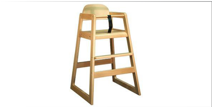
Kinderhochstuhl Holz, Buche stapelbar fest verschraubte und verleimte Holzverbindungen eingedübelte Kunststoffgleiter Kippsicherheit durch ausgestellte Beine ergonomisch geformte Sitzfläche und Rückenlehne weich gerundete Sitzvorderkante für angenehmes Sitzen Art. 114858
