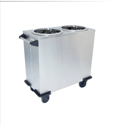
Röhrenstapler RRV-2 RIEBER Edelstahl rostfrei 18/10 - unbeheizt, ohne Haube Korpus doppelwandig, isoliert stoßgeschützte Schaltelemente flexibler Einstellmechanismus für Teller ø 190 - 320 mm Röhrendurchmesser: 397 mm Zuladung pro Röhre max. 75 kg Fassungsvermögen von ca. 60 Tellern pro Röhre Plattform kipp- und verkantsicher geführt Ausgabehöhe verstellbar über Federn Sicherheitsschiebegriff. 4 Stoßecken Rostfreie Rollenausstattung Rollen ø 125 mm, 2 Lenkrollen, 2 Lenkstopprollen 95.5x48 cm h 90 cm, Gewicht 35 kg • Art. 119329
