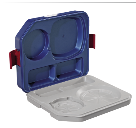
Speisentransportbehälter BLU TRAY isoliertes, passives Speisentransporttablett zum Warm- oder Kalthalten Polypropylen, ausgeschäumt mit Polyurethan Deckel blau metallic, Unterteil grau passiv beheizt durch Heizeinlett mit Aluminiumkern Warm- und Kaltbereiche sind thermisch getrennt Temperatureinsatzbereich: -20°C bis + 100°C jedes Porzellanteil ist separat und dicht abgedeckt spülmaschinentauglich mit 2 Bügelverschlüssen kurzfristige thermische Desinfektion bis +130°C möglich 37x53 cm h 11.4 cm • Art. 127476 bestückt mit 1 Hauptspeiseteller, 3-geteilt 1 Suppentasse 2 Kaltschalen 4 Abdeckungen
