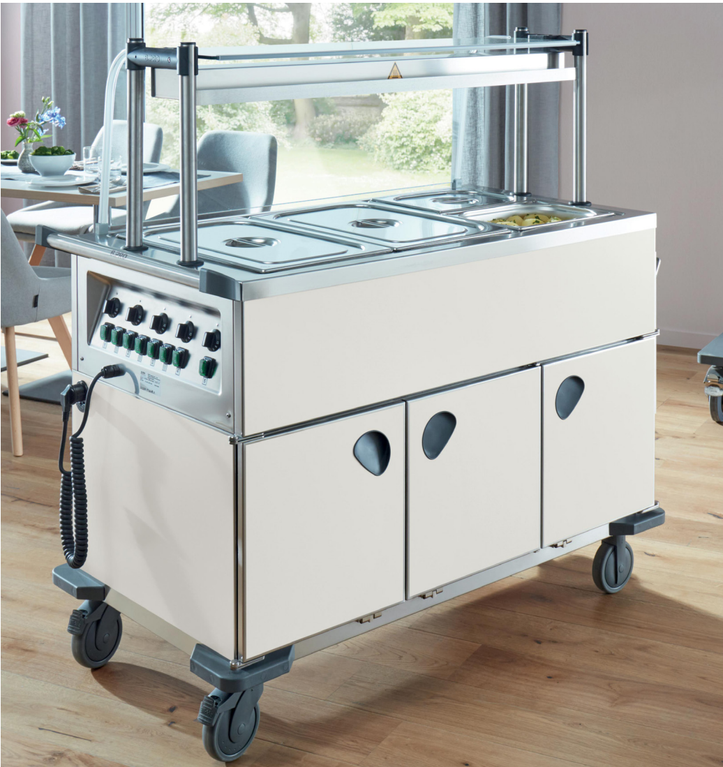
Speiseausgabewagen SAG3 B.PRO Edelstahl rostfrei 18/10 3 Schankräume naß und trocken beheizbar, 30°C bis 80°C mit je 6 Paar Auflagesicken für GN1/1 mit Abstand 57.5 mm Becken separat regel- und beheizbar für 3 x GN1/1 200 mm, Temperaturregler von 30°C bis 95°C Griffstellung stirnseitig, 4 Stoßbecken geprägte Füllstandsmarkierung in den Becken Ablasshahn gegen unbeabsichtigtes Öffnen gesichert Spritz- und strahlwassergeschützt, Arbeitshöhe 900 mm Kunststoffrollen, rostfrei ø 125 mm, 2 Lenkrollen, 2 Lenkstopprollen Bedienfeld mit Ein-/Aus-Schalter, Kontroll-Leuchte, Spiralkabel-Anschluss mit Blindsteckerbuchse Nennspannung 220-240 V, 50 Hz, Anschlußwert 2.85 kW 127.6x71.4 cm h 93.3 cm, Leergewicht 85.5 kg • Art. 119358
