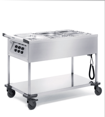
Speiseausgabewagen SAW3 B.PRO Edelstahl rostfrei 18/10, naß und trocken beheizbar 3 Warmhaltebecken - fugenlos eingeschweißt, tiefgezogen offenes Untergestell mit abgekanteten Ablagebord, eingeschweißt Becken separat regel- und beheizbar für 3 x GN 1/1-200 mm Stufenlose Temp.einstellung je Becken: +30°C bis +95°C Sicherheitsschiebegriff mit seitlichen Stoßschutz- Elementen, geprägte Füllstandsmarkierung (4 Liter) in den Becken Ablasshahn gegen unbeabsichtigtes Öffnen gesichert Spritz- und strahlwassergeschützt, Arbeitshöhe 90 cm Kunststoffrollen ø 125 mm, 2 Lenkrollen, 2 Lenkstopprollen Bedienfeld mit Ein-/Aus-Schalter, Kontrollleuchte, Spiralkabel, Blindsteckerbuchse und Temperaturregler an Stirnseite Nennspannung 220-240 V, 50-60 Hz, Anschlußwert 2.1 kW 127.6x71.4 cm h 93.3 cm, Leergewicht 44 kg • Art. 119357
