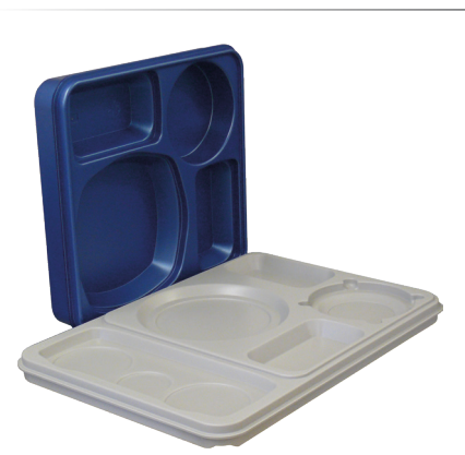
Speisentransportbehälter BLU TRAY ITALY isoliertes, passives Speisentransporttablett zum Warm- oder Kalthalten Polypropylen, ausgeschäumt mit Polyurethan Deckel blau metallic, Unterteil grau leichte, robuste Bauweise bestehend aus Ober- und Unterteil Warm- und Kaltbereiche sind thermisch getrennt Temperatureinsatzbereich: -20°C bis + 100°C spülmaschinentauglich kurzfristige thermische Desinfektion bis +130°C möglich 37x53 cm h 10 cm • Art. 127477 unbestückt
