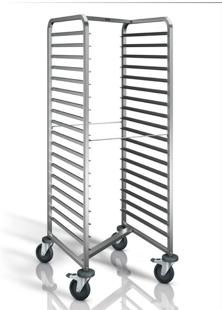
Regalwagen 18 Tablett RWRR 161 B.PRO Edelstahl rostfrei 18/10 raumsparend ineinander zu schieben (leerer Zustand) Auflagenpaare: 18 , Auflagenabstand: 73 mm Kapazität: 18 GN 2/1 oder 36 GN 1/1 Tragfähigkeit: 200 kg Rollen: ø 125 mm, stahlverzinkt 4 Lenkrollen, davon 2 mit Feststeller 66.2x73.4 cm h 164.5 cm • Art. 116823
