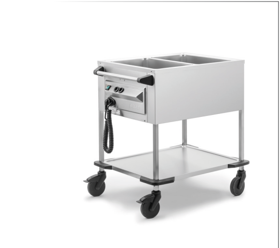
Zubringerwagen ZUB2 RIEBER Edelstahl rostfrei 18/10 naß und trocken beheizbar Fassungsvermögen 2 x GN1/1 200 mm Abdeckung allseitig verkröpft, tiefgezogene Warmhaltebecken eingeschweißt isoliert, spritzwassergeschützt Sicherheitsschiebegriff, Griffstellung stirnseitig Eingeschweißtes Edelstahl-Bord, 4 Stoßbecken Bei trockener Beheizung deutliche Energiesparnis Mit Entleerhahn Schaltelemente stoßgeschützt Spiralkabel 2.5 m, Blindsteckdose , Ein-/Aus-Wippschalter Thermostatregler stufenlos, +30 °C bis +110 °C Rostfreie Rollenausstattung ø 125 mm, 2 Lenkrollen Nennspannung 1N AC 230V, 50 Hz, Anschlußwert 0.94 kW 85.8x67.5 cm h 90 cm, Leergewicht 33 kg • Art. 119316
