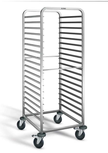
Regalwagen für 18 Tablett RWR 161 B.PRO Edelstahl rostfrei 18/10 Auflagenpaare: 18 Auflagenabstand: 73 mm Kapazität: 18 GN 2/1 oder 36 GN 1/1 Tragfähigkeit: 200 kg Rollen: ø 125 mm, stahlverzinkt 4 Lenkrollen, davon 2 mit Feststeller 66.2x73.4 cm h 164.5 cm • Art. 116824
