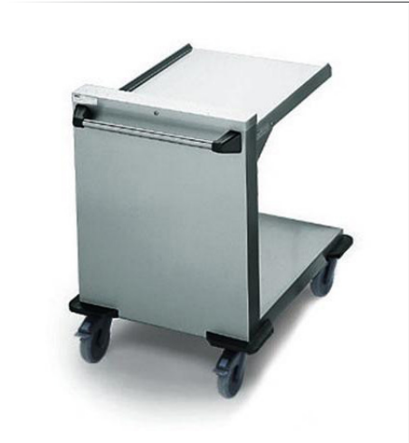
Plattformstapler offen - SV2/1 RIEBER Edelstahl rostfrei 18/10 Plattformabmessung 81.2x54.5 cm Korb-, Tablettabmessung 53x80 cm Gewicht ca. 43 kg Zuladung max 200 kg Fassungsvermögen Körbe: 12 x (53x40x8.5 cm) oder 8 x (53x40x12 cm) Plattform kipp- und verkantsicher 4 Stoßecken Rostfreie Rollenausstattung 2 Lenkrollen und 2 Lenkstopprollen ø 125 mm Federkraft je nach Tablett-, Geschirrgewicht einstellbar Sicherheitsschiebegriff Stapelhöhe ca. 57.5 cm 105x69 cm h 91.1 cm • Art. 119332
