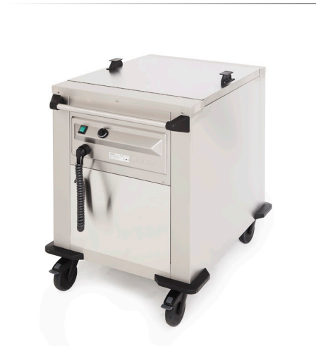
Plattformstapler - umluftbeheizt GN 2/1 RIEBER Edelstahl rostfrei 18/10 Plattformabmessungen 53,5 x66,0 cm Korb-/Tablettabmessung: max. 53 x 65 cm geschlossen-, doppelwandig isoliert, mit Edelstahl- Deckel stirnseitig einhängbar, mit Auflagerahmen, Sicherheitsschiebegriff, 4 Stoßecken, rostfreie Rollen (2 Lenk- & 2 Lenkstopprollen), ø125 mm Gewicht: 70.2 kg, Zuladung max 200 kg Heizbereich +30° C bis +100° C Nennspannung: 1N AC 230 V 50/60 Hz 99x69 cm h 91.1 cm • Art. 128023
