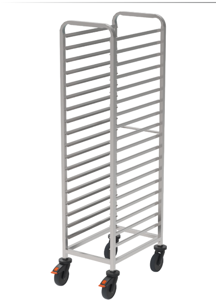
Regalwagen RW-180-1/1-A RIEBER Edelstahl rostfrei 18/10, Quadratrohrgestell Anzahl Auflageschienen: 18, U-förmig mit Kippsicherung Lichtmaß zwischen den Schienen: 73 mm Für GN 1/1, GN 2/3, GN 1/3, GN 1/2 und GN 2/4 Gesamttragkraft: 210 kg Tragkraft je Auflagepaar: 25 kg Raddurchmesser 125 mm 44.5x61.9 cm h 164.1 cm • Art. 119315
