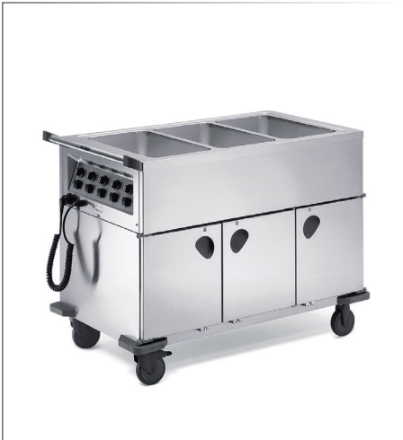
Speiseausgabewagen SAG3 B.PRO Edelstahl rostfrei 18/10 3 Schankräume naß und trocken beheizbar, 30°C bis 80°C mit je 6 Paar Auflagesicken für GN1/1 mit Abstand 57.5 mm Becken separat regel- und beheizbar für 3 x GN1/1 200 mm, Temperaturregler von 30°C bis 95°C Griffstellung stirnseitig, 4 Stoßbecken geprägte Füllstandsmarkierung in den Becken Ablasshahn gegen unbeabsichtigtes Öffnen gesichert Spritz- und strahlwassergeschützt, Arbeitshöhe 900 mm Kunststoffrollen, rostfrei ø 125 mm, 2 Lenkrollen, 2 Lenkstopprollen Bedienfeld mit Ein-/Aus-Schalter, Kontroll-Leuchte, Spiralkabel-Anschluss mit Blindsteckerbuchse Nennspannung 220-240 V, 50 Hz, Anschlußwert 2.85 kW 127.6x71.4 cm h 93.3 cm, Leergewicht 85.5 kg • Art. 119358
