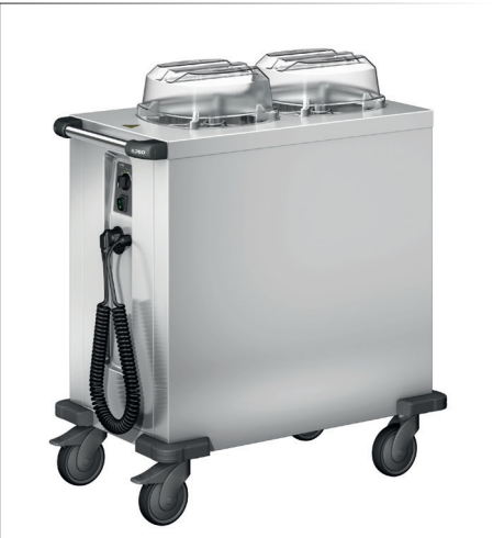
Tellerspender 2 SHE 21-26 B.PRO Edelstahl rostfrei 18/10 statisch beheizbar inkl. Stülpedeckel runde Tellerröhren Temperatur regelbar von +30°C bis +110°C Kapazität: ca. 120 Teller, rund ø 21-26 cm mit Kunststoffrollen, rostfrei Rollen ø 125 mm, 4 Lenkrollen, davon 2 mit Feststeller Gewicht: 45 kg Leistung: 1.8 kW 220-240 V, 50-60 Hz 88.5x52 cm h 93.7 cm • Art. 116833
