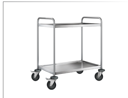
Servierwagen 8x5x2 B.PRO 2 Ablagen Edelstahl rostfrei 18/10 lichtes Maß zwischen den Borden: 58.5 cm Maße der Borde: 80x50 cm Tragfähigkeit je Ablage: max. 80 kg Tragfähigkeit je Wagen: 120 kg Maße: 90x60 cm h 95 cm Gewicht (Kunststoffrollen): 15 kg Rollen ø 125 mm, 4 Lenkrollen, davon 2 mit Feststeller • Art. 125990 Rollen aus Kunststoff • Art. 119716 Rollen stahlverzinkt
