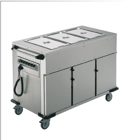
Speisentransportwagen Norm-III-3 RIEBER Edelstahl rostfrei 18/10, naß und trocken beheizbar Fassungsvermögen 3 x GN1/1 200 mm Abdeckung mit Schwallrand 4 Stoßbecken, Griffstellung stirnseitig tiefgezogene Warmhaltebecken eingeschweißt, mit Ablauf Türen doppelwandig, isoliert, selbstschließend Abmessungen pro Fach 33x57 cm h 36.4 cm mit je 8 Paar fugenlos tiefgezogenen Auflagesicken mit Abstand 37 mm, für GN-Behälter bis zu GN 1/1 Raddurchmesser 125 mm, 2 Bockrollen, 2 Lenkstopprollen Schankraum beheizt, ein Heizelement pro Schankraum 1/1 Spiralkabel 2 m, Blindsteckdose Thermostatregler stufenlos, von 30°C - 110°C Nennspannung 1N AC 230V, 50/60 Hz Anschlußwert 2.82 kW 131.4x68 cm h 90 cm, Leergewicht 120 kg • Art. 119320
