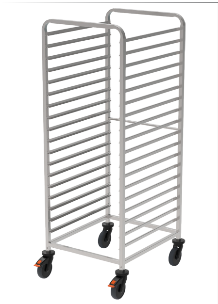
Regalwagen RW-180-1A RIEBER Edelstahl rostfrei 18/10, Quadratrohrgestell Anzahl Auflageschienen: 18, U-förmig mit Kippsicherung Lichtmaß zwischen den Schienen: 73 mm Für GN 2/1, GN 1/1 und GN 2/4 Gesamttragkraft: 210 kg Tragkraft je Auflagepaar: 25 kg Raddurchmesser 125 mm 64.8x73.9 cm h 164.1 cm • Art. 119314
