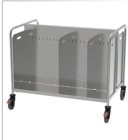
Stapelwagen einteilig Edelstahl 1.4301 (CNS) Gewicht 30 kg max. Zuladung 150 kg 4 Abweiserrollen für Rammschutz ø 12.5 cm 2 Lenk-, 2 Lenkstopprollen 120x50 cm h 97 cm • Art. 125980
