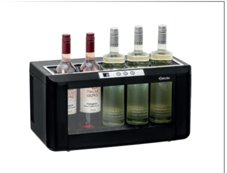
Flaschenkühler Kunststoff LED-Beleuchtung, separat schaltbar Fassungsvermögen: 4-5 Flaschen Flaschen-Öffnung: 430 x 100 mm thermoelektrische Kühlung 1 Temperaturzone von 5°C bis 18°C elektronische Temperaturregelung In 1 °C-Stufen Anschlußwert: 0.05 kW 230 V * 50/60 Hz 50x26.5 cm h 26 cm Gewicht 7.1 kg Art. 130095
