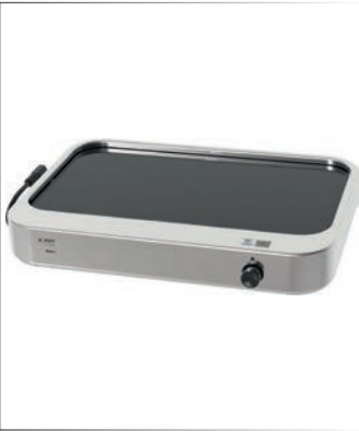
Dispositivo da appoggio K-POT 1 zona 1/1 CH-800, apparecchio per mantenere in caldo Dispositivo per mantenere controllatamente caldi i cibi nel formato GN 1/1. Il mantenimento continuo garantisce la temperatura ottimale senza far seccare o bruciare i piatti, in combinazione con pentola GN thermoplates®. Piano in vetroceramica incassato, facile da pulire. Selettore rotativo per regolazione continua. LED indica lo stato operativo. dimensioni esterne: 53.3 x 38 cm, h 8.8 cm peso: 6.5 kg potenza elettrica collegata: 1 N AC 230 V 50/60 Hz potenza: 800 W Art. 125988 Corpo in acciaio, laccato nero Art. 125987
