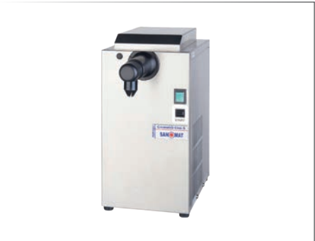
Sifone per panna CREMALDI-UNO-5 acciaio inossidabile 18/10 porzionamento manuale, raffreddamento nel beccuccio decorativo, pulizia disinfettante tramite lavaggio a flusso, interruttori robusti, accensione/spegnimento separata per dispositivo e raffreddamento, con automazione di pulizia, capacità fino a 75 l di panna all'ora 230V~1 / 50-60 Hz 22,8x34,6 cm h 45,9 cm, 26 kg, capacità 2 l Art. 120538
