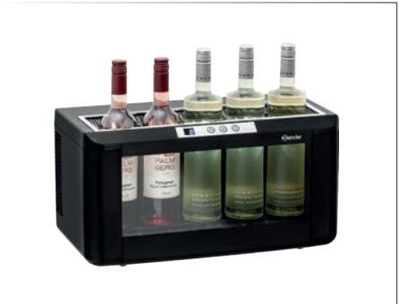
Portabottiglie refrigerato plastica illuminazione a LED, commutabile separatamente capacità: 4-5 bottiglie apertura della bottiglia: 430 x 100 mm raffreddamento termoelettrico 1 zona di temperatura da 5° C a 18° C controllo della temperatura elettronico a passi di 1° C carico collegato: 0,05 kW 230 V * 50/60 Hz 50x26,5 cm h 26 cm peso 7,1 kg Art. 130095
