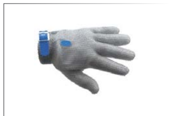
Schutzhandschuh Beidhändig, aus Stahl AISI 316 L, geschweißte Ringe, Außen ø 4 mm - Draht ø 0,5 mm, Nylonband Large / 27 cm - blau Art. 33935
