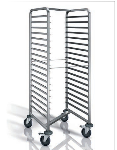
Regalwagen 18 Tablett RWRR 161 B.PRO Edelstahl rostfrei 18/10 raumsparend ineinander zu schieben (leerer Zustand) Auflagenpaare: 18, Auflagenabstand: 73 mm Kapazität: 18 GN 2/1 oder 36 GN 1/1 Tragfähigkeit: 200 kg Rollen: ø 125 mm, stahlverzinkt 4 Lenkrollen, davon 2 mit Feststeller 66.2x73.4 cm h 164.5 cm • Art. 116823
