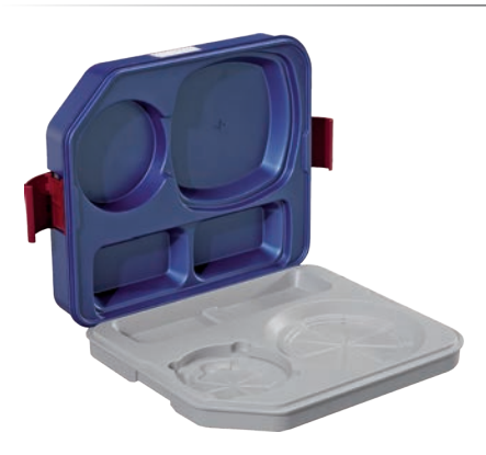
Speisentransportbehälter BLU TRAY COMPACT isoliertes, passives Speisentransporttablett zum Warm- oder Kalthalten Polypropylen, ausgeschäumt mit Polyurethan Deckel blau metallic, Unterteil grau Warm- und Kaltbereiche sind thermisch getrennt Temperatureinsatzbereich: -20°C bis + 100°C spülmaschinentauglich mit 2 Bügelverschlüssen kurzfristige thermische Desinfektion bis +130°C möglich 37x44.2 cm h 10.3 cm • Art. 127475 unbestückt
