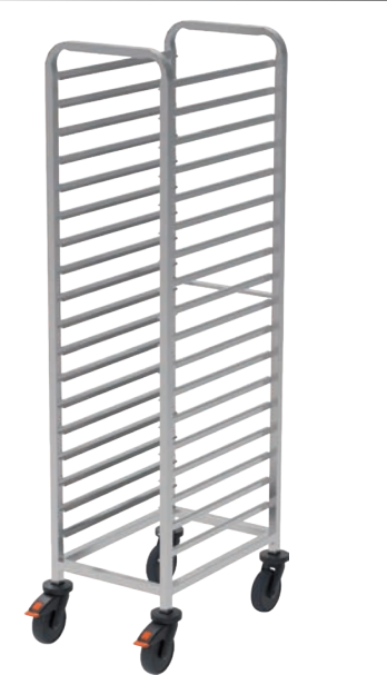
Regalwagen RW-180-1/1-A RIEBER Edelstahl rostfrei 18/10, Quadratrohrgestell Anzahl Auflageschienen: 18, U-förmig mit Kippsicherung Lichtmaß zwischen den Schienen: 73 mm Für GN 1/1, GN 2/3, GN 1/3, GN 1/2 und GN 2/4 Gesamttragkraft: 210 kg Tragkraft je Auflagepaar: 25 kg Raddurchmesser 125 mm 44.5x61.9 cm h 164.1 cm • Art. 119315
