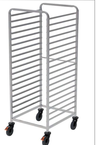
Regalwagen RW-180-1A RIEBER Edelstahl rostfrei 18/10, Quadratrohrgestell Anzahl Auflageschienen: 18, U-förmig mit Kippsicherung Lichtmaß zwischen den Schienen: 73 mm Für GN 2/1, GN 1/1 und GN 2/4 Gesamttragkraft: 210 kg Tragkraft je Auflagepaar: 25 kg Raddurchmesser 125 mm 64.8x73.9 cm h 164.1 cm • Art. 119314
