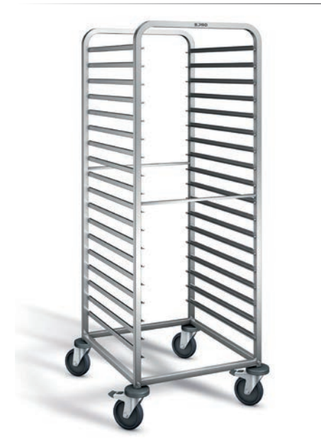
Regalwagen für 18 Tablett RWR 161 B.PRO Edelstahl rostfrei 18/10 Auflagenpaare: 18 Auflagenabstand: 73 mm Kapazität: 18 GN 2/1 oder 36 GN 1/1 Tragfähigkeit: 200 kg Rollen: ø 125 mm, stahlverzinkt 4 Lenkrollen, davon 2 mit Feststeller 66.2x73.4 cm h 164.5 cm • Art. 116824
