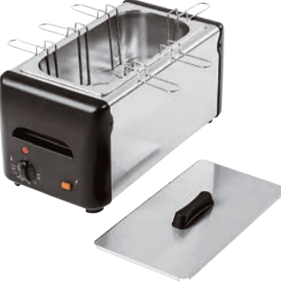
Eierkocher mit Thermostat Temperaturbegrenzer Ein-/Ausschalter mit 6 nummerierten Körbchen für max. 10 Eier 42x22 cm h 23 cm GN 1/3 230V, 1500W, 4.5 kg Art. 107956
